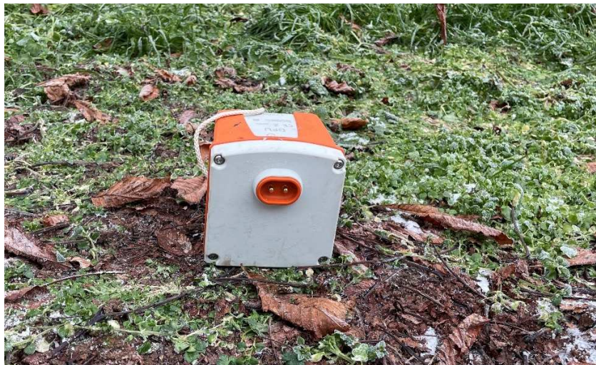
Bild: Geophon, mit dem die seismischen Wellen erfasst werden
